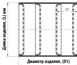
Чертеж пламегасителя коллекторного секционного ZeroNoise
